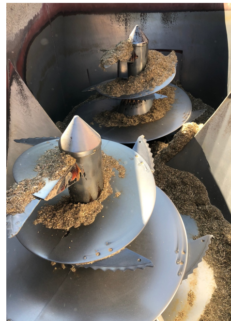
Abb 4: Verschleiß an Messer und Schnecken verschlechtert die Mischqualität und verursacht Probleme durch Verschleppung. Dadurch verstärkte Schwankungen des pH-Wertes im Pansen können eine verstärkte Bildung giftiger Lipopolysaccharide Gesundheitsprobleme verursachen.
